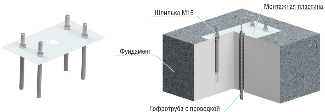
Рисунок 7.2.1 Устройство фундамента с монтажным комплектом
