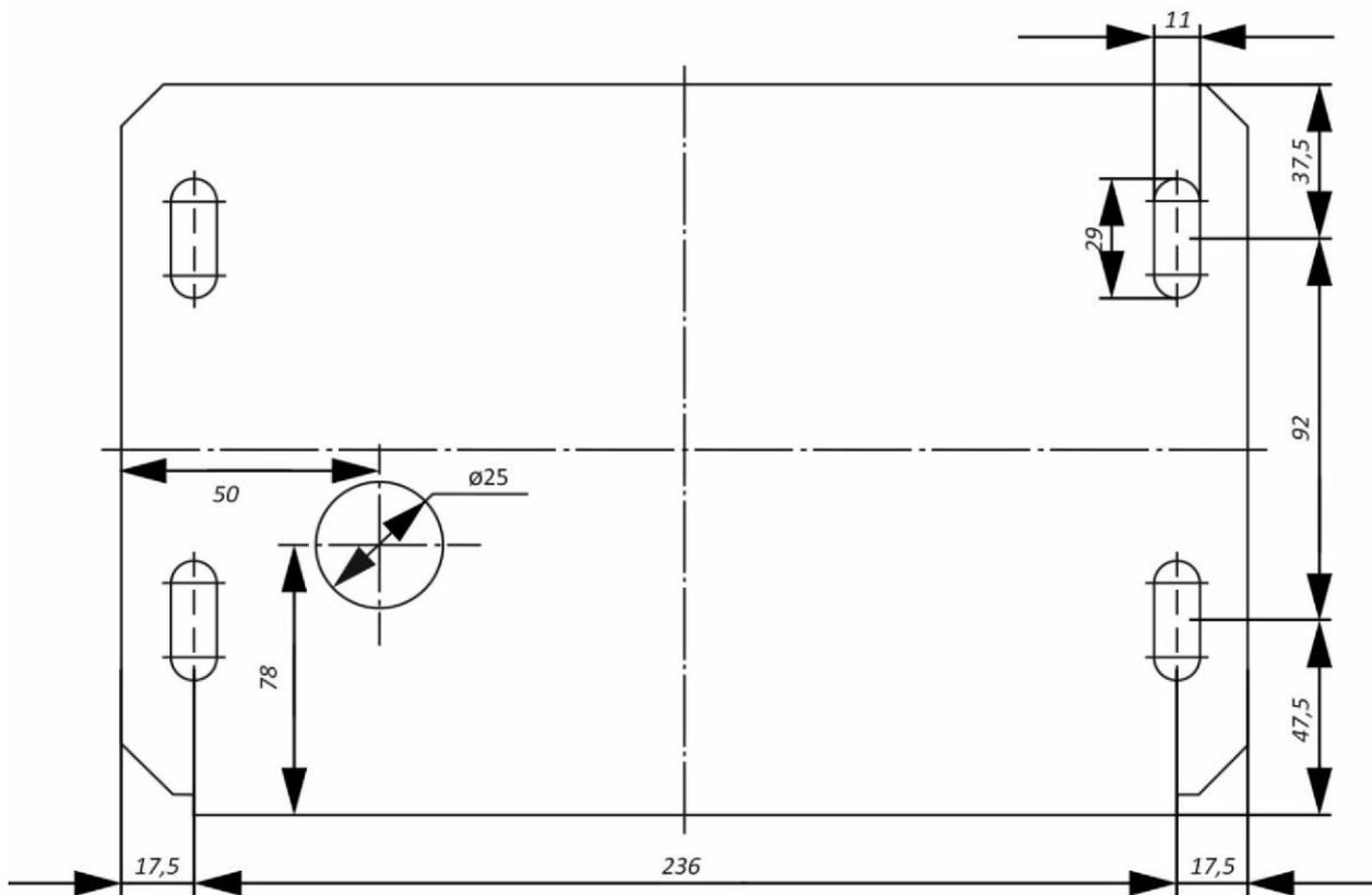
Рис. 2. Размеры для монтажа, мм
