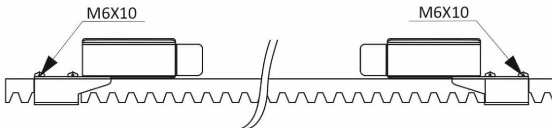
Рис. 8. Схема установки кронштейнов.
