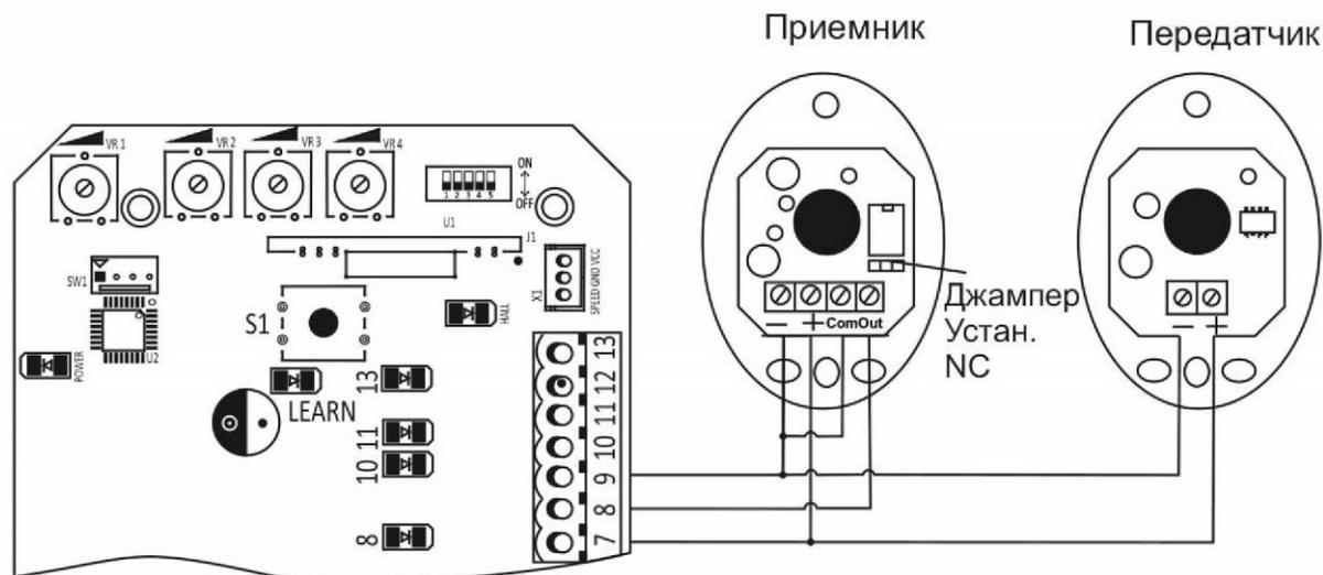
Рис. 12. Подключение фотоэлементов.
