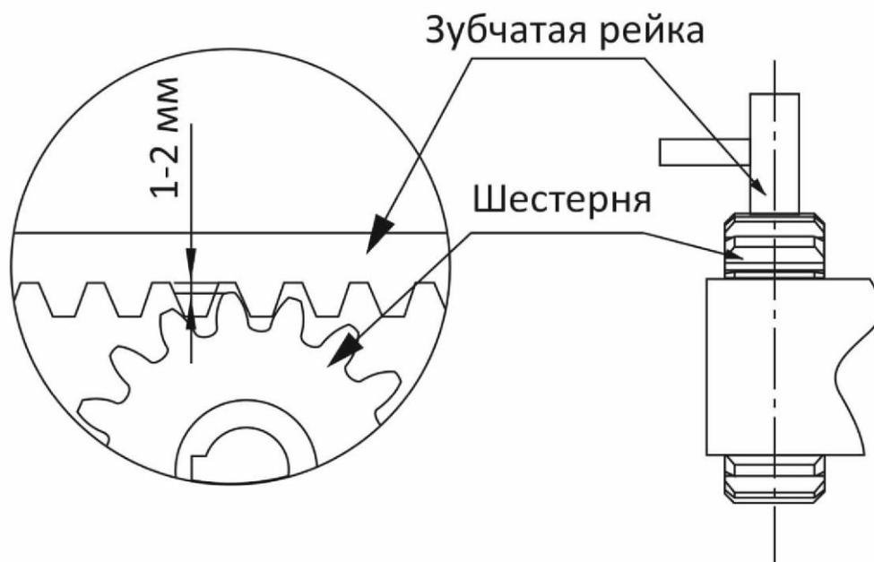
Рис. 7. Зазор между зубчатой рейкой и шестерней.
